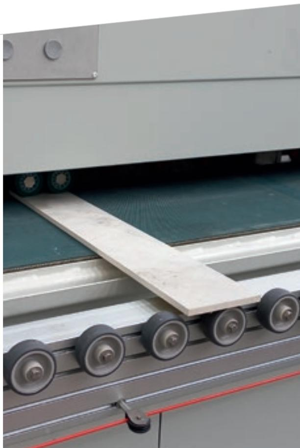
Ruote pressori duplex per lunghezza testa minima di 150 mm.
