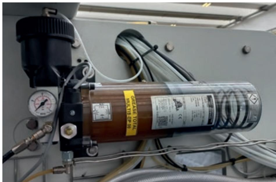
Ridotta manutenzione grazie alla lubrificazione automatica centralizzata di serie.
